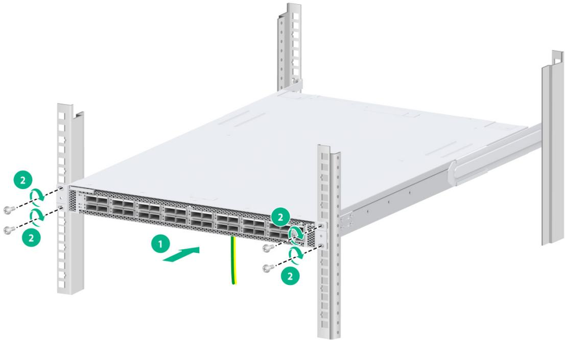
图2-14 安装 S9800-24B8D 和 S9800-32D 以太网交换机到机柜示意图（挂耳安装在靠近电源侧）
