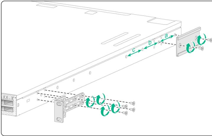
图2-9 安装挂耳和滑道导轨到 S9800-24B8D 和 S9800-32D 机箱（采用电源侧挂耳安装位）
