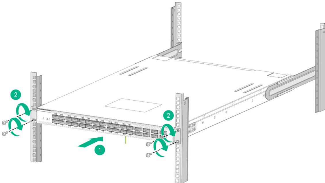
图2-13 安装 S9800-32D 以太网交换机到机柜示意图（挂耳安装在靠近端口侧）
